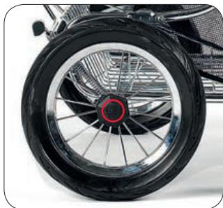
Tag bort axelskydden och spara dem för framtida bruk (skydd vid transport utan hjul). Se till att parkeringsbromsen är i uppfällt läge. För på hjulet på axeln så långt som möjligt med låsknappen intryckt. Släpp knappen och kontrollera att hjulet sitter fast.
