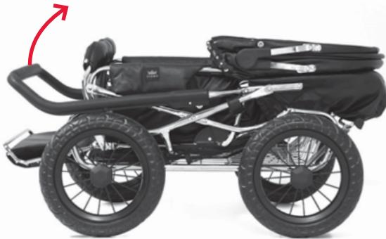
Fäll upp chassit genom att lyfta i skjutstången. Se till att chassilåsen låser på båda sidorna och att låspinnen låser i säkerhetslåset så som bilderna visar.
